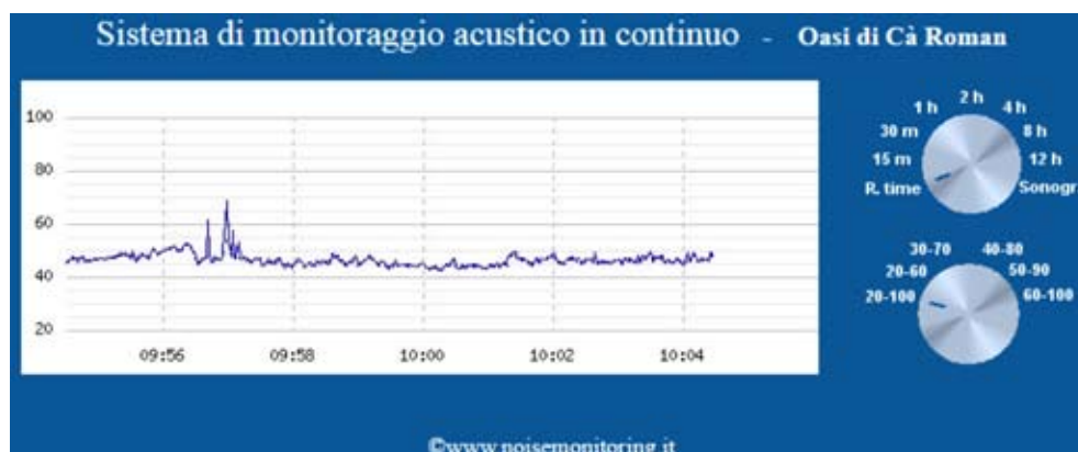
3. Esempio di visualizzazione da remoto della time history del livello di pressione sonora misurato da una centralina di monitoraggio in tempo reale.
